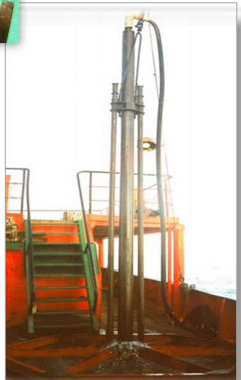
Гидроударная установка УГВП-150
